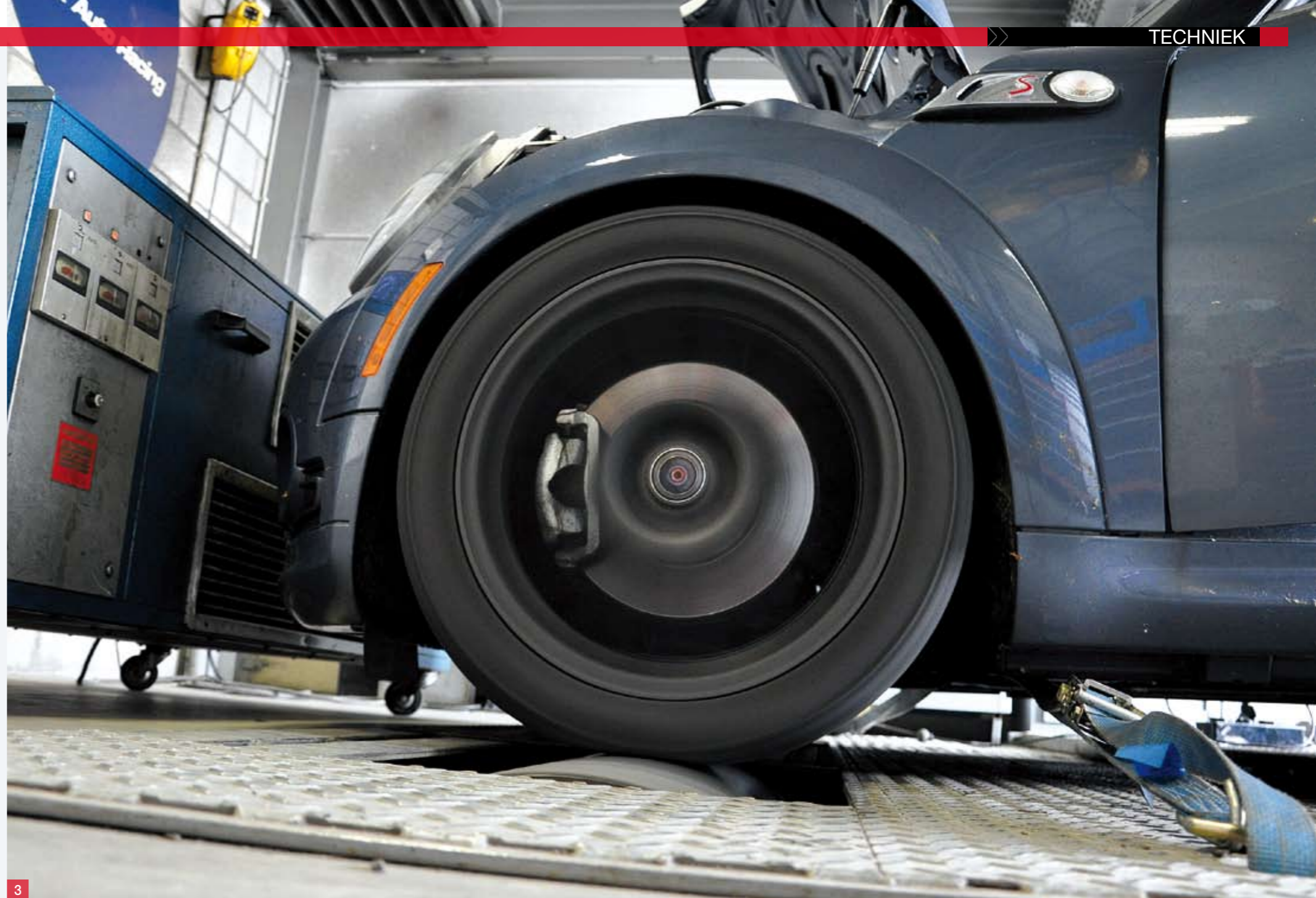
1 | Het optimaliseren van de software gaat niet zonder slag of stoot, omdat de nieuwe Bosch ECU nog gekraakt moet worden. 2 | Nu we er toch zijn... De Mini wordt meteen maar uitgerust met een JCW remmenset. 3 | Met aangepaste software en uitlaat wordt 217 pk en 307 Nm gescoord. Een fors vermoegen voor een verder originele 1.6 turbomotor.
