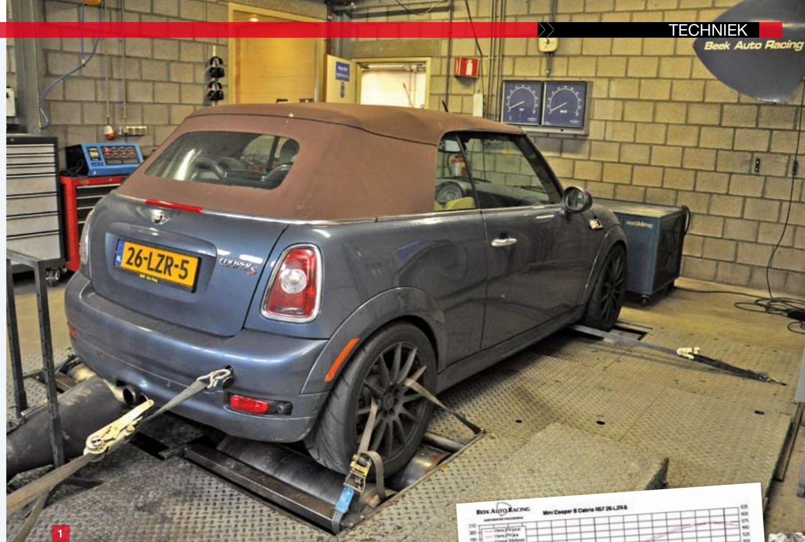
1 | De nulmeting levert 190 pk op. Met nieuw uitlaatsysteem en nog zonder aangepaste software komt er 5 pk bij. 2 | Prachtig detail zijn de carbon eindstukken.
