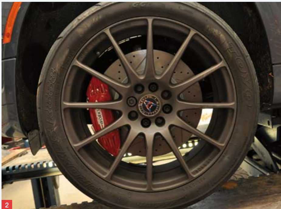
1 | Het optimaliseren van de software gaat niet zonder slag of stoot, omdat de nieuwe Bosch ECU nog gekraakt moet worden. 2 | Nu we er toch zijn... De Mini wordt meteen maar uitgerust met een JCW remmenset. 3 | Met aangepaste software en uitlaat wordt 217 pk en 307 Nm gescoord. Een fors vermoegen voor een verder originele 1.6 turbomotor.
